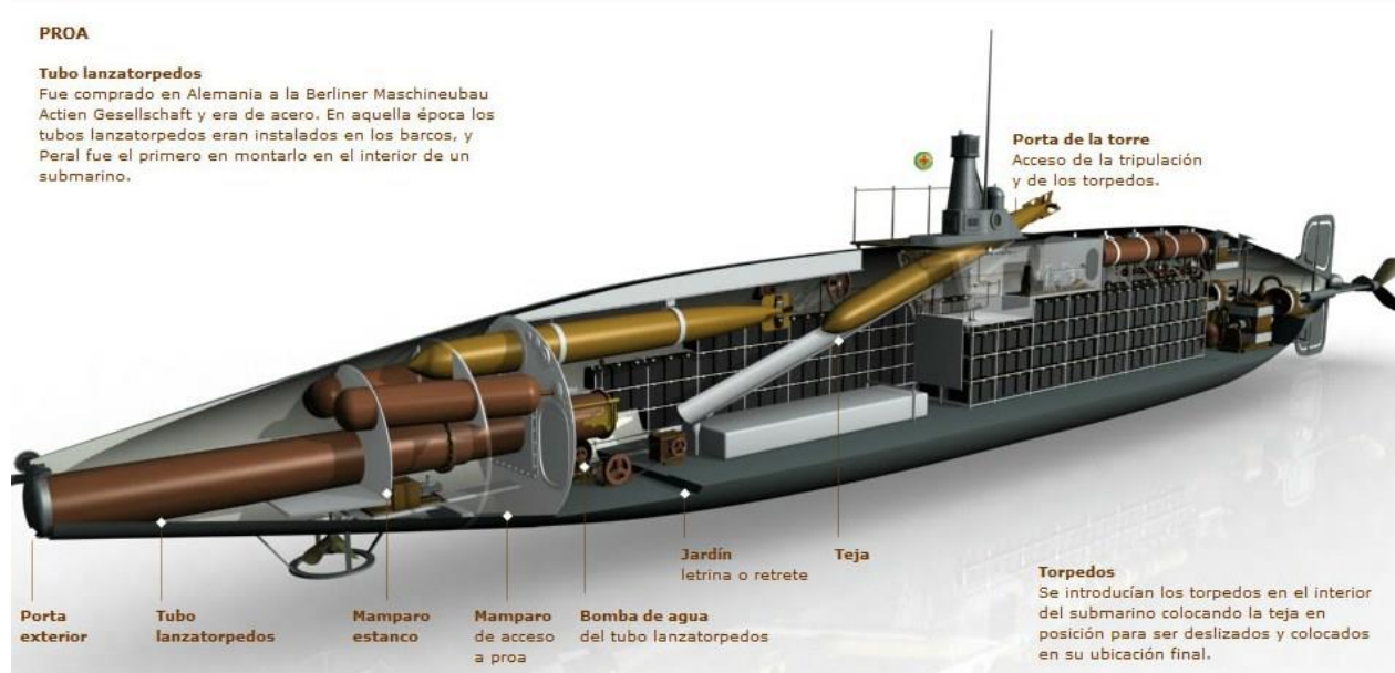
Рис. 3. Устройство подводной лодки Исаака Переля
