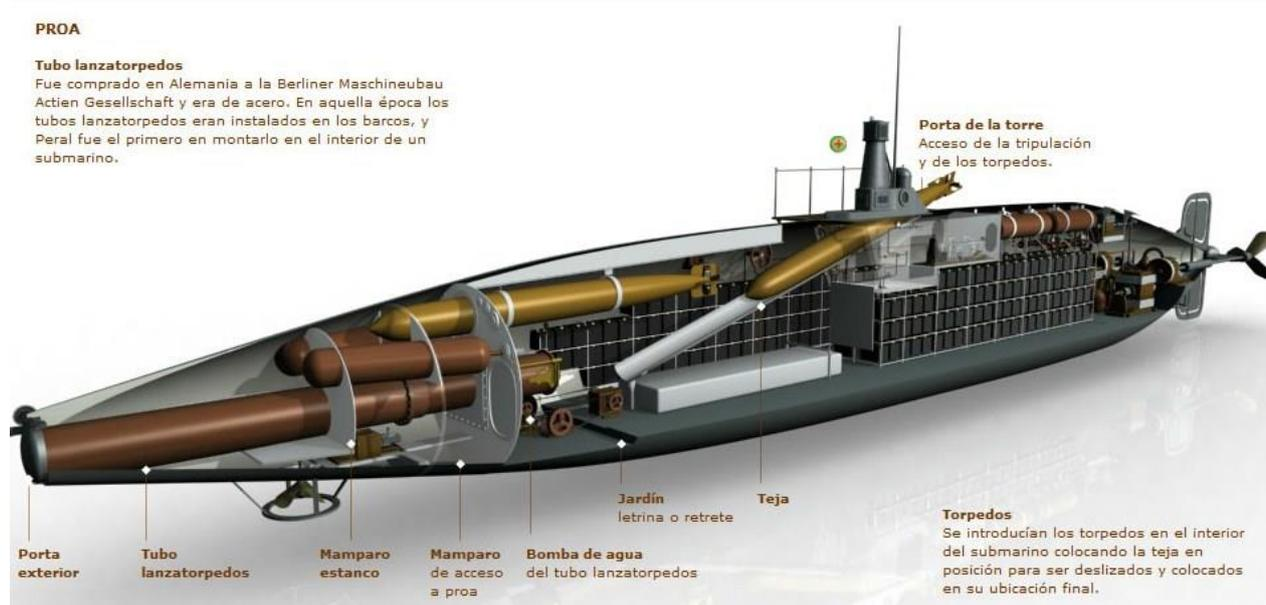
**Рис. 3.** Устройство подводной лодки Исаака Переля
