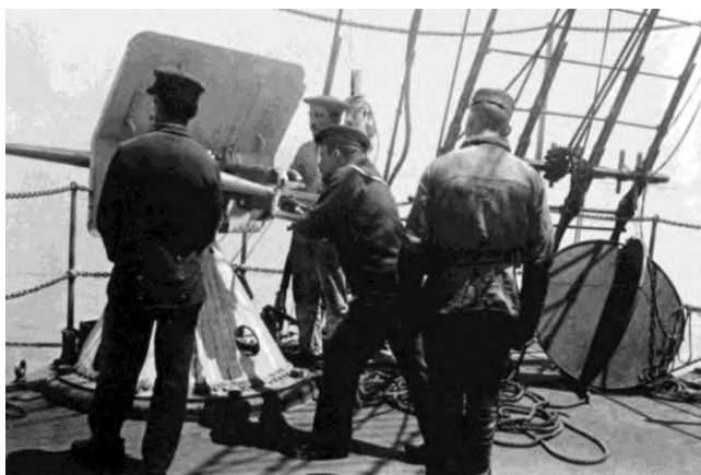
57-мм орудие Норденфelta на броненосце «Relayo» (слева) и на крейсере «Carlos V» (справа)
