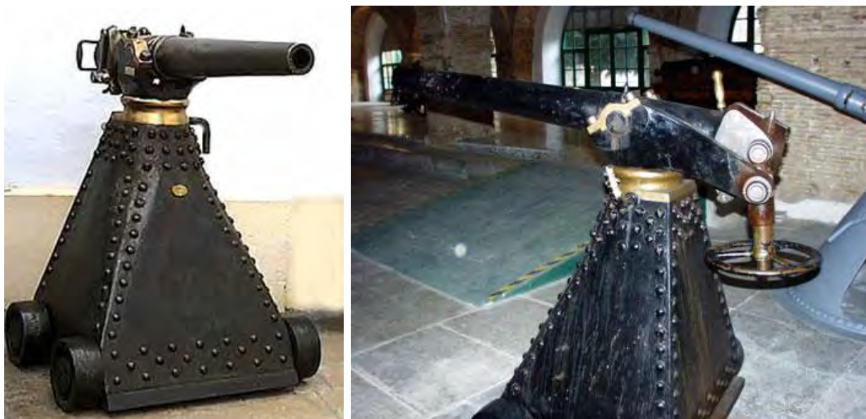
75-мм орудие Норденфельта на капонирном станке
