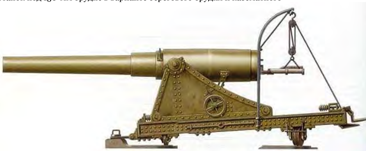
Станок под 150-мм орудие в варианте берегового орудия и казематного
