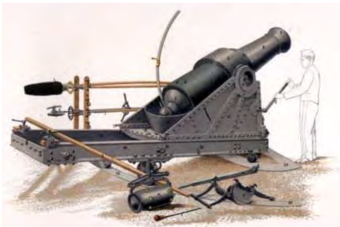
210-мм чугунная гаубица на станке образца 1870 г. на станке образца 1872 г.
