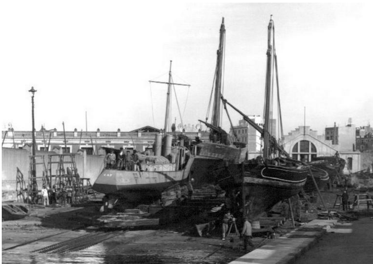
"Крусеро" постройки Сестао в сухом доке Барселоны. Хорошо видны две стоящие бок о бок дымовые трубы
