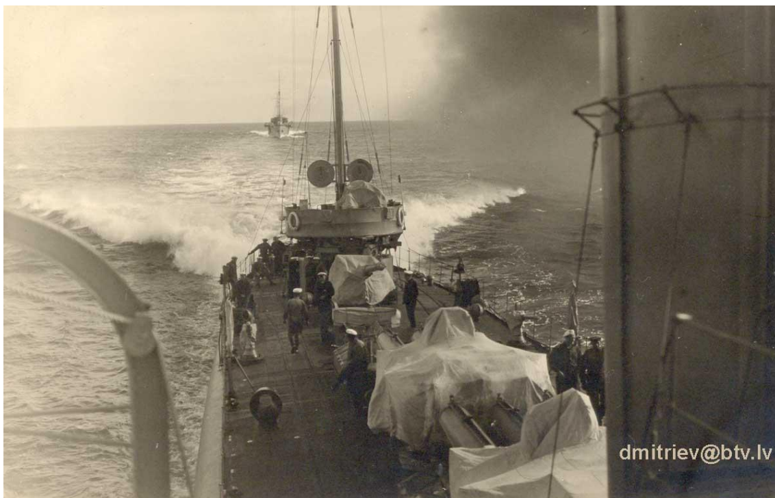
Орудия и торпедные аппараты зачехленные по-походному
