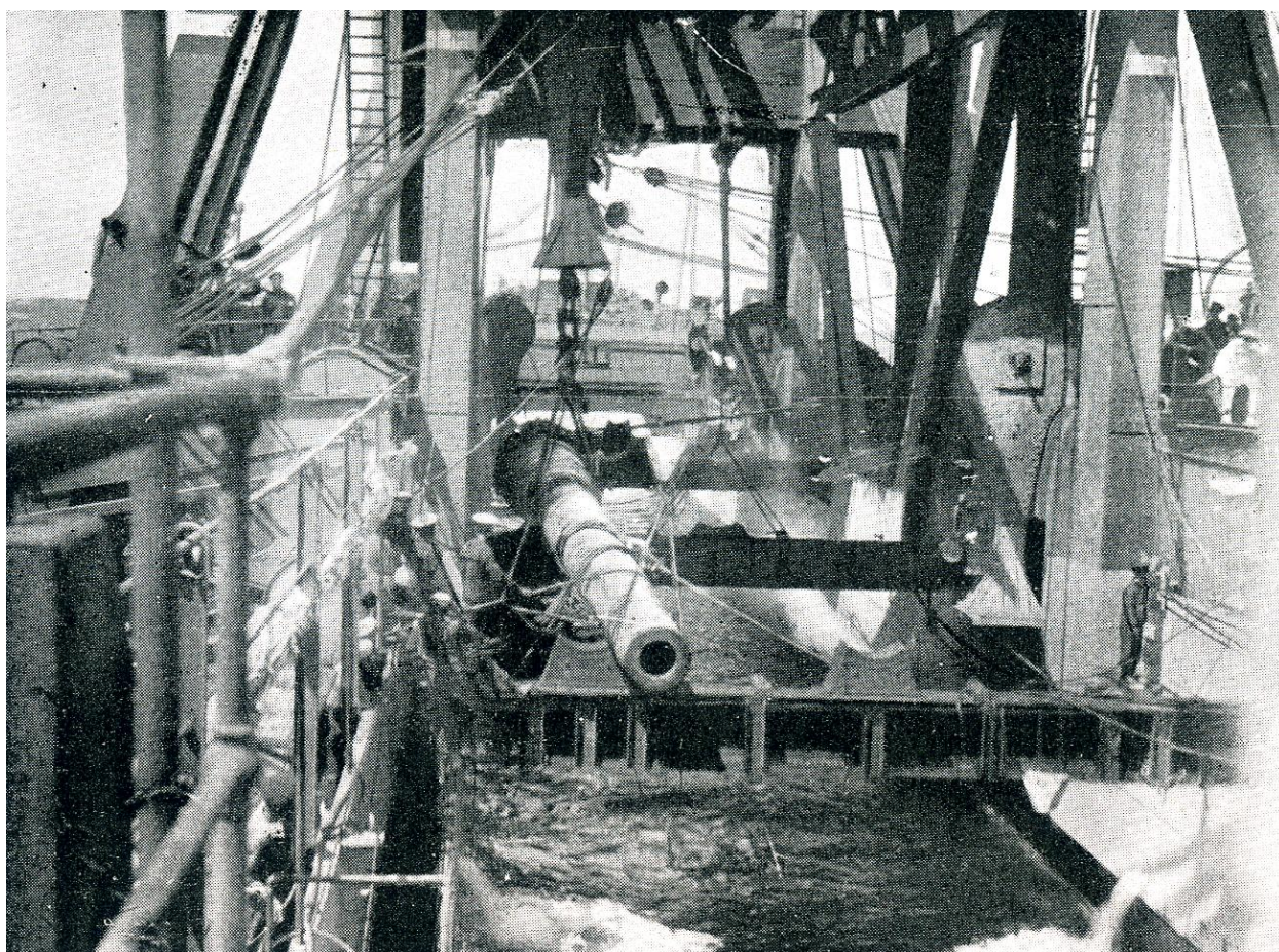
Рис. 29. Размещение одного из орудий на «Kanguro» ( Miranda y Maristany, 1924 )
